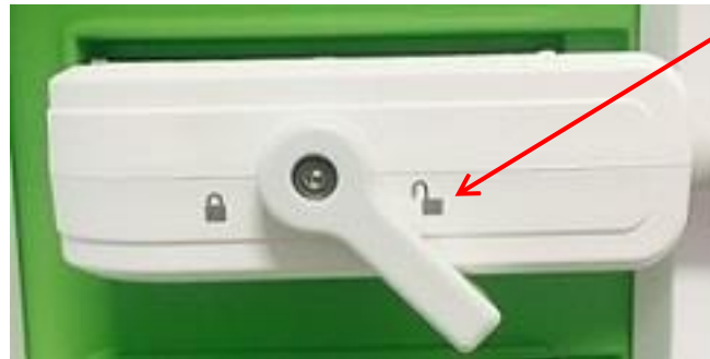
図11：ロック解除したトランスデューサコネクタロックつまみ
