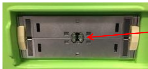
図9：トランスデューサコネクタスロットのロックノッチ
