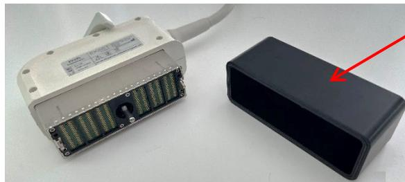
Figure 32 : Cache du connecteur de la sonde verrouillable
