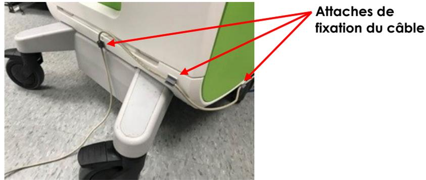
Figure 4 : Fixation du câble de la pédale
