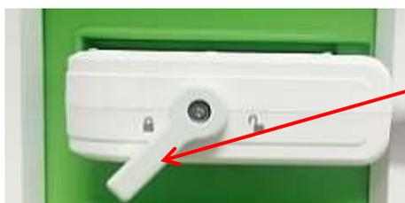
Figure 28 : Orientation du connecteur de la sonde
