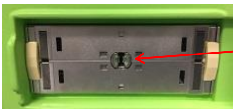
Rysunek 7: Wycięcie blokujące w gnieździe złącza głowicy
