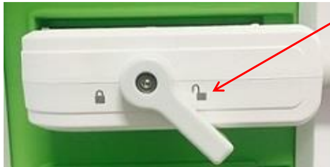
Фигура 11: Отключено копче за заключване на конектора на трансдюсера
