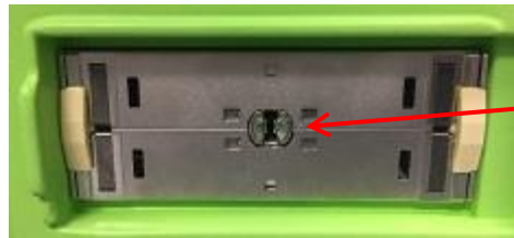
Фигура 9: Заклучващ прорез на гнездото за конектор на трансдюсера
